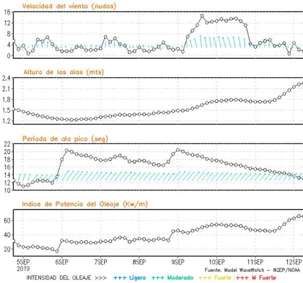
**Figura 8.** Series de tiempo de la velocidad del viento (nudos), altura de olas (m), periodo de la ola (s) e índice de la potencia del oleaje (Kw/m) frente a las costas de Talara, Callao e Ilo, del 04-09-2019 al 11-09-2019 Fuente: Datos: modelo WWATCH III; Grafico: DHN
