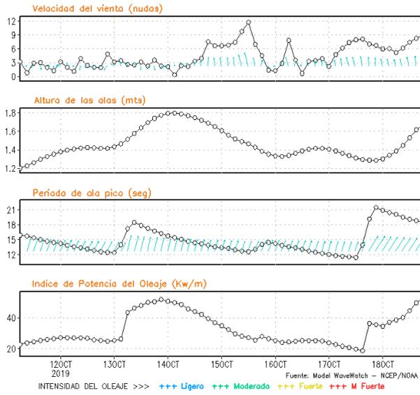
**Figura 8.** Series de tiempo de la velocidad del viento (nudos), altura de olas (m), periodo de la ola (s) e índice de la potencia del oleaje (Kw/m) frente a las costas de Talara, Callao e Ilo, del 11-10-2019 al 18-10-2019 Fuente: Datos: modelo WWATCH III; Grafico: DHN
