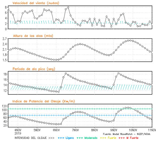
**Figura 8.** Series de tiempo de la velocidad del viento (nudos), altura de olas (m), periodo de la ola (s) e índice de la potencia del oleaje (Kw/m) frente a las costas de Talara, Callao e Ilo, del 03-11-2019 al 10-11-2019 Fuente: Datos: modelo WWATCH III; Grafico: DHN
