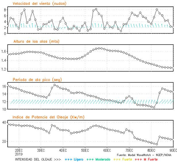
**Figura 8.** Series de tiempo de la velocidad del viento (nudos), altura de olas (m), periodo de la ola (s) e índice de la potencia del oleaje (Kw/m) frente a las costas de Talara, Callao e Ilo, del 01-12-2019 al 08-12-2019 Fuente: Datos: modelo WWATCH III; Grafico: DHN
