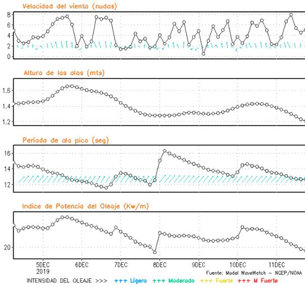
**Figura 8.** Series de tiempo de la velocidad del viento (nudos), altura de olas (m), periodo de la ola (s) e índice de la potencia del oleaje (Kw/m) frente a las costas de Talara, Callao e Ilo, del 04-12-2019 al 11-12-2019 Fuente: Datos: modelo WWATCH III; Grafico: DHN
