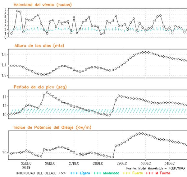
**Figura 8.** Series de tiempo de la velocidad del viento (nudos), altura de olas (m), periodo de la ola (s) e índice de la potencia del oleaje (Kw/m) frente a las costas de Talara, Callao e Ilo, del 24-12-2019 al 31-12-2019 Fuente: Datos: modelo WWATCH III; Grafico: DHN
