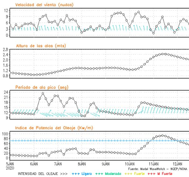
**Figura 8.** Series de tiempo de la velocidad del viento (nudos), altura de olas (m), periodo de la ola (s) e índice de la potencia del oleaje (Kw/m) frente a las costas de Talara, Callao e Ilo, del 05-01-2020 al 12-01-2020 Fuente: Datos: modelo WWATCH III; Grafico: DHN
