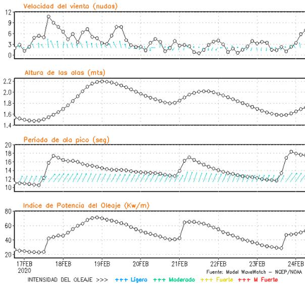
**Figura 8.** Series de tiempo de la velocidad del viento (nudos), altura de olas (m), periodo de la ola (s) e índice de la potencia del oleaje (Kw/m) frente a las costas de Talara, Callao e Ilo, del 16-02-2020 al 23-02-2020 Fuente: Datos: modelo WWATCH III; Grafico: DHN
