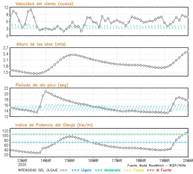
**Figura 8.** Series de tiempo de la velocidad del viento (nudos), altura de olas (m), periodo de la ola (s) e índice de la potencia del oleaje (Kw/m) frente a las costas de Talara, Callao e Ilo, del 12-03-2020 al 19-03-2020 Fuente: Datos: modelo WWATCH III; Grafico: DHN
