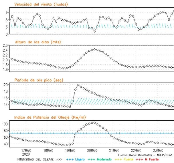
**Figura 8.** Series de tiempo de la velocidad del viento (nudos), altura de olas (m), periodo de la ola (s) e índice de la potencia del oleaje (Kw/m) frente a las costas de Talara, Callao e Ilo, del 16-03-2020 al 23-03-2020 Fuente: Datos: modelo WWATCH III; Grafico: DHN
