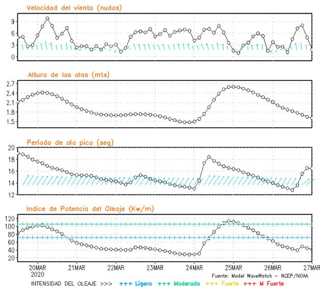
**Figura 8.** Series de tiempo de la velocidad del viento (nudos), altura de olas (m), periodo de la ola (s) e índice de la potencia del oleaje (Kw/m) frente a las costas de Talara, Callao e Ilo, del 19-03-2020 al 26-03-2020 Fuente: Datos: modelo WWATCH III; Grafico: DHN
