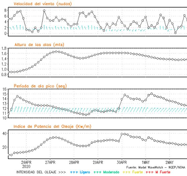
**Figura 8.** Series de tiempo de la velocidad del viento (nudos), altura de olas (m), periodo de la ola (s) e índice de la potencia del oleaje (Kw/m) frente a las costas de Talara, Callao e Ilo, del 25-04-2020 al 02-05-2020 Fuente: Datos: modelo WWATCH III; Grafico: DHN
