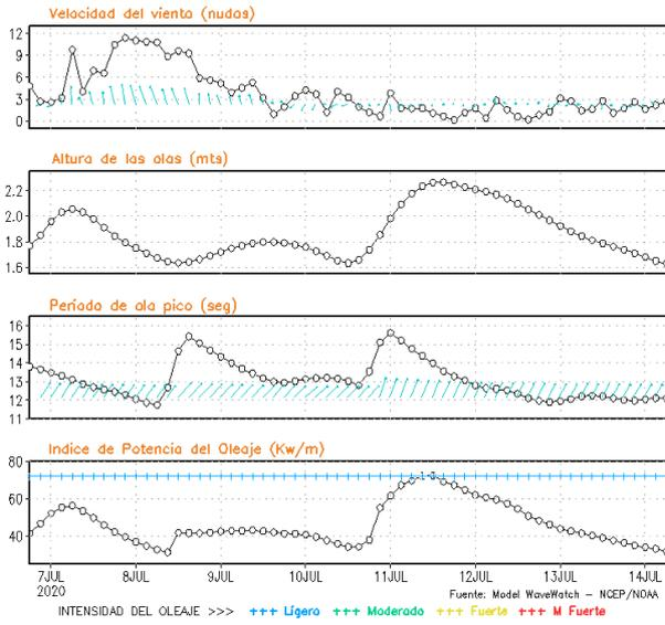
**Figura 8.** Series de tiempo de la velocidad del viento (nudos), altura de olas (m), periodo de la ola (s) e índice de la potencia del oleaje (Kw/m) frente a las costas de Talara, Callao e Ilo, del 06-07-2020 al 13-07-2020 Fuente: Datos: modelo WWATCH III; Grafico: DHN
