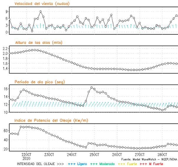
**Figura 8.** Series de tiempo de la velocidad del viento (nudos), altura de olas (m), periodo de la ola (s) e índice de la potencia del oleaje (Kw/m) frente a las costas de Talara, Callao e Ilo, del 21-10-2020 al 28-10-2020 Fuente: Datos: modelo WWATCH III; Grafico: DHN
