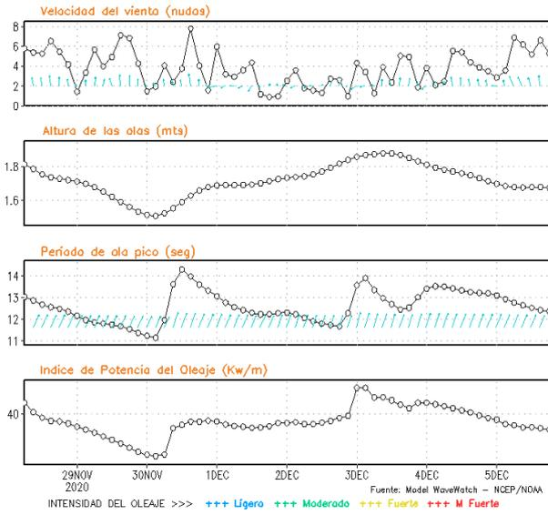
**Figura 8.** Series de tiempo de la velocidad del viento (nudos), altura de olas (m), periodo de la ola (s) e índice de la potencia del oleaje (Kw/m) frente a las costas de Talara, Callao e Ilo, del 28-11-2020 al 05-12-2020 Fuente: Datos: modelo WWATCH III; Grafico: DHN
