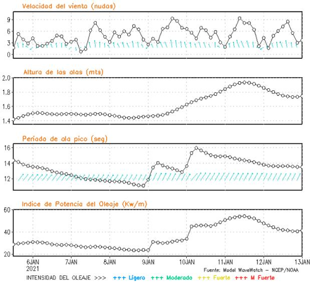
**Figura 8.** Series de tiempo de la velocidad del viento (nudos), altura de olas (m), periodo de la ola (s) e índice de la potencia del oleaje (Kw/m) frente a las costas de Talara, Callao e Ilo, del 05-01-2021 al 12-01-2021 Fuente: Datos: modelo WWATCH III; Grafico: DHN
