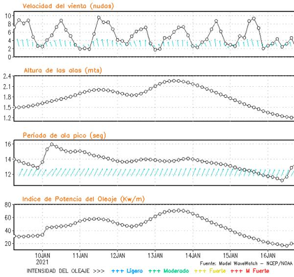
**Figura 8.** Series de tiempo de la velocidad del viento (nudos), altura de olas (m), periodo de la ola (s) e índice de la potencia del oleaje (Kw/m) frente a las costas de Talara, Callao e Ilo, del 09-01-2021 al 16-01-2021 Fuente: Datos: modelo WWATCH III; Grafico: DHN
