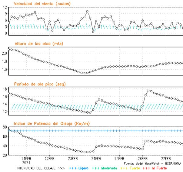
**Figura 8.** Series de tiempo de la velocidad del viento (nudos), altura de olas (m), periodo de la ola (s) e índice de la potencia del oleaje (Kw/m) frente a las costas de Talara, Callao e Ilo, del 20-02-2021 al 27-02-2021 Fuente: Datos: modelo WWATCH III; Grafico: DHN
