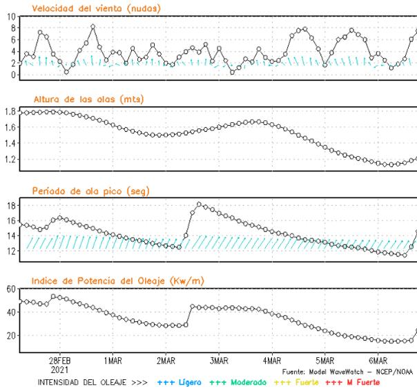
**Figura 8.** Series de tiempo de la velocidad del viento (nudos), altura de olas (m), periodo de la ola (s) e índice de la potencia del oleaje (Kw/m) frente a las costas de Talara, Callao e Ilo, del 27-02-2021 al 06-03-2021 Fuente: Datos: modelo WWATCH III; Grafico: DHN
