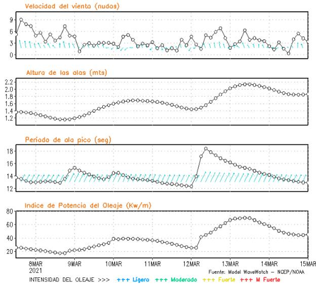
**Figura 8.** Series de tiempo de la velocidad del viento (nudos), altura de olas (m), periodo de la ola (s) e índice de la potencia del oleaje (Kw/m) frente a las costas de Talara, Callao e Ilo, del 07-03-2021 al 14-03-2021 Fuente: Datos: modelo WWATCH III; Grafico: DHN
