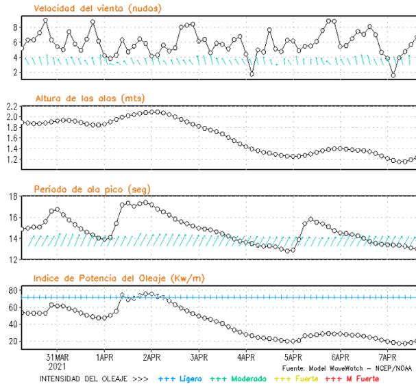
**Figura 8.** Series de tiempo de la velocidad del viento (nudos), altura de olas (m), periodo de la ola (s) e índice de la potencia del oleaje (Kw/m) frente a las costas de Talara, Callao e Ilo, del 30-03-2021 al 06-04-2021 Fuente: Datos: modelo WWATCH III; Grafico: DHN
