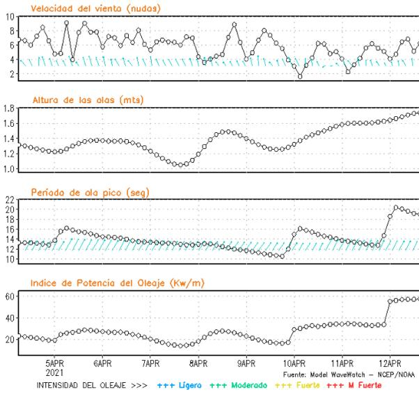
**Figura 8.** Series de tiempo de la velocidad del viento (nudos), altura de olas (m), periodo de la ola (s) e índice de la potencia del oleaje (Kw/m) frente a las costas de Talara, Callao e Ilo, del 04-04-2021 al 11-04-2021 Fuente: Datos: modelo WWATCH III; Grafico: DHN
