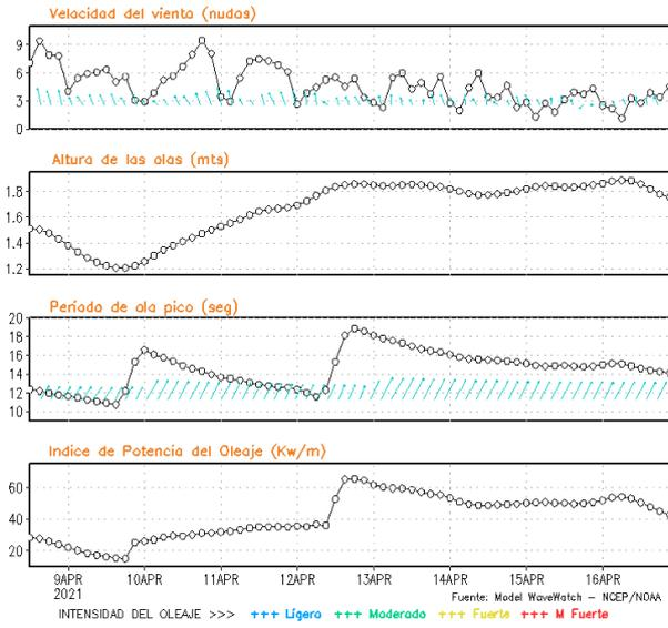
**Figura 8.** Series de tiempo de la velocidad del viento (nudos), altura de olas (m), periodo de la ola (s) e índice de la potencia del oleaje (Kw/m) frente a las costas de Talara, Callao e Ilo, del 08-04-2021 al 15-04-2021 Fuente: Datos: modelo WWATCH III; Grafico: DHN
