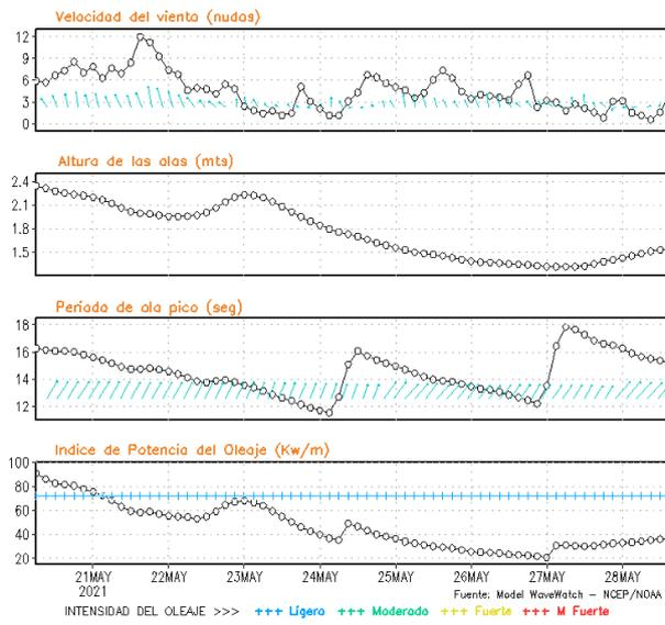
**Figura 8.** Series de tiempo de la velocidad del viento (nudos), altura de olas (m), periodo de la ola (s) e índice de la potencia del oleaje (Kw/m) frente a las costas de Talara, Callao e Ilo, del 21-05-2021 al 28-05-2021 Fuente: Datos: modelo WWATCH III; Grafico: DHN
