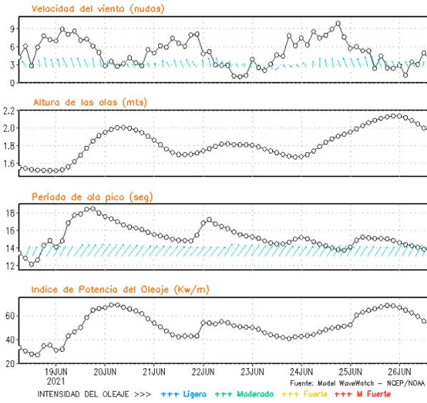
**Figura 8.** Series de tiempo de la velocidad del viento (nudos), altura de olas (m), periodo de la ola (s) e índice de la potencia del oleaje (Kw/m) frente a las costas de Talara, Callao e Ilo, del 18-06-2021 al 25-06-2021 Fuente: Datos: modelo WWATCH III; Grafico: DHN
