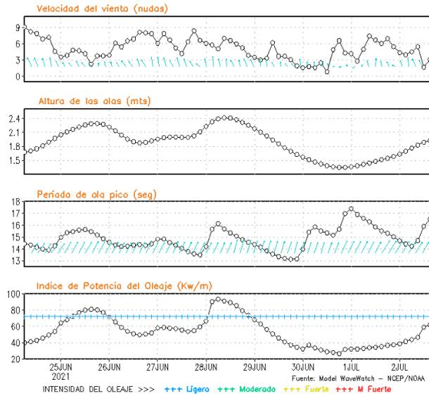
**Figura 8.** Series de tiempo de la velocidad del viento (nudos), altura de olas (m), periodo de la ola (s) e índice de la potencia del oleaje (Kw/m) frente a las costas de Talara, Callao e Ilo, del 24-06-2021 al 01-07-2021 Fuente: Datos: modelo WWATCH III; Grafico: DHN
