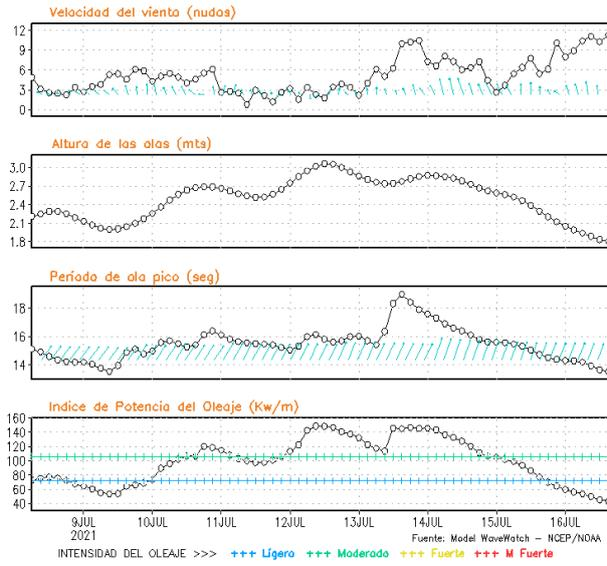
**Figura 8.** Series de tiempo de la velocidad del viento (nudos), altura de olas (m), periodo de la ola (s) e índice de la potencia del oleaje (Kw/m) frente a las costas de Talara, Callao e Ilo, del 08-07-2021 al 15-07-2021 Fuente: Datos: modelo WWATCH III; Grafico: DHN
