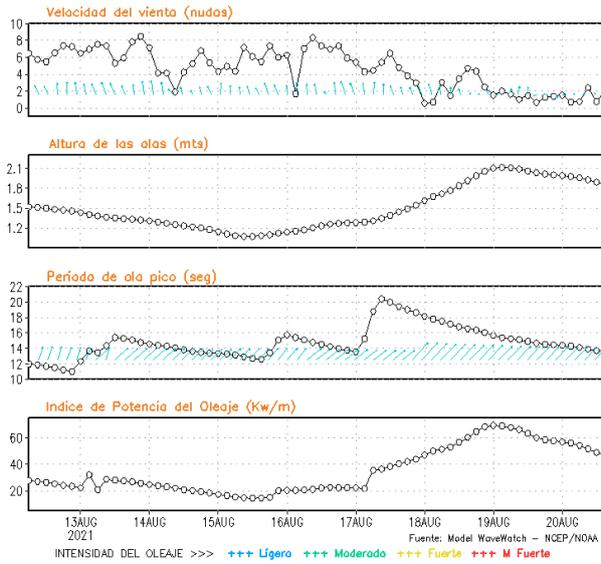
**Figura 8.** Series de tiempo de la velocidad del viento (nudos), altura de olas (m), periodo de la ola (s) e índice de la potencia del oleaje (Kw/m) frente a las costas de Talara, Callao e Ilo, del 12-08-2021 al 19-08-2021 Fuente: Datos: modelo WWATCH III; Grafico: DHN
