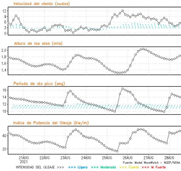
**Figura 8.** Series de tiempo de la velocidad del viento (nudos), altura de olas (m), periodo de la ola (s) e índice de la potencia del oleaje (Kw/m) frente a las costas de Talara, Callao e Ilo, del 22-08-2021 al 29-08-2021 Fuente: Datos: modelo WWATCH III; Grafico: DHN
