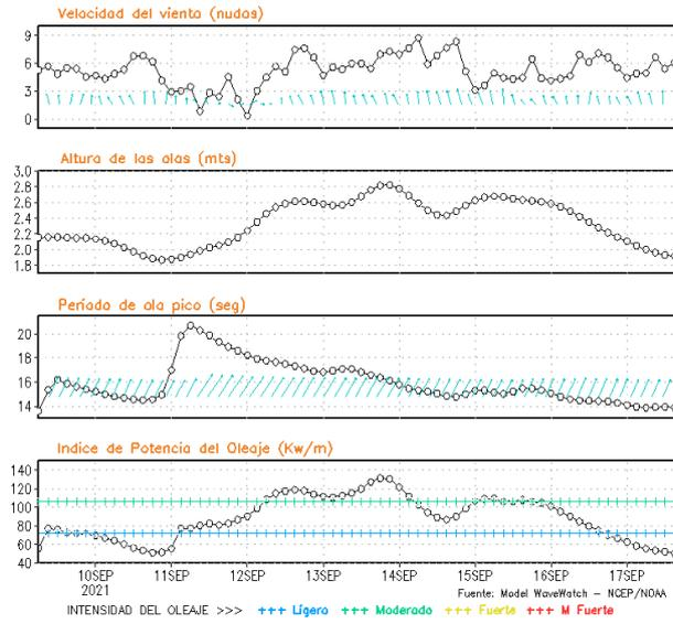
**Figura 8.** Series de tiempo de la velocidad del viento (nudos), altura de olas (m), periodo de la ola (s) e índice de la potencia del oleaje (Kw/m) frente a las costas de Talara, Callao e Ilo, del 09-09-2021 al 16-09-2021 Fuente: Datos: modelo WWATCH III; Grafico: DHN
