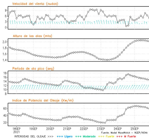
**Figura 8.** Series de tiempo de la velocidad del viento (nudos), altura de olas (m), periodo de la ola (s) e índice de la potencia del oleaje (Kw/m) frente a las costas de Talara, Callao e Ilo, del 20-09-2021 al 27-09-2021 Fuente: Datos: modelo WWATCH III; Grafico: DHN
