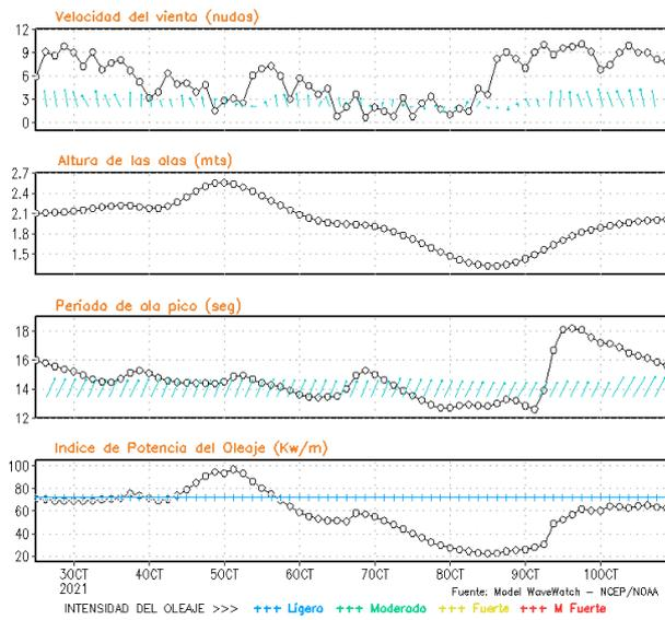
**Figura 8.** Series de tiempo de la velocidad del viento (nudos), altura de olas (m), periodo de la ola (s) e índice de la potencia del oleaje (Kw/m) frente a las costas de Talara, Callao e Ilo, del 03-10-2021 al 10-10-2021 Fuente: Datos: modelo WWATCH III; Grafico: DHN
