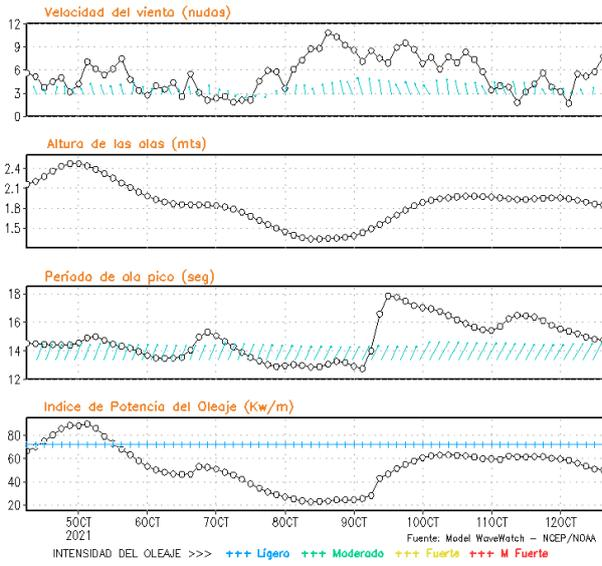
**Figura 8.** Series de tiempo de la velocidad del viento (nudos), altura de olas (m), periodo de la ola (s) e índice de la potencia del oleaje (Kw/m) frente a las costas de Talara, Callao e Ilo, del 04-10-2021 al 11-10-2021 Fuente: Datos: modelo WWATCH III; Grafico: DHN
