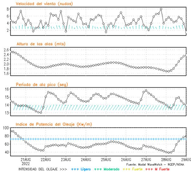
**Figura 8.** Series de tiempo de la velocidad del viento (nudos), altura de olas (m), periodo de la ola (s) e índice de la potencia del oleaje (Kw/m) frente a las costas de Talara, Callao e Ilo, del 20-08-2022 al 27-08-2022 Fuente: Datos: modelo WWATCH III; Grafico: DHN
