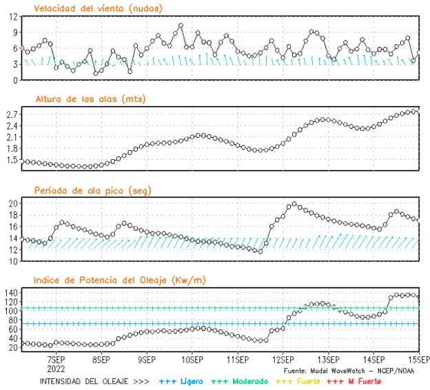
**Figura 8.** Series de tiempo de la velocidad del viento (nudos), altura de olas (m), periodo de la ola (s) e índice de la potencia del oleaje (Kw/m) frente a las costas de Talara, Callao e Ilo, del 06-09-2022 al 13-09-2022 Fuente: Datos: modelo WWATCH III; Grafico: DHN
