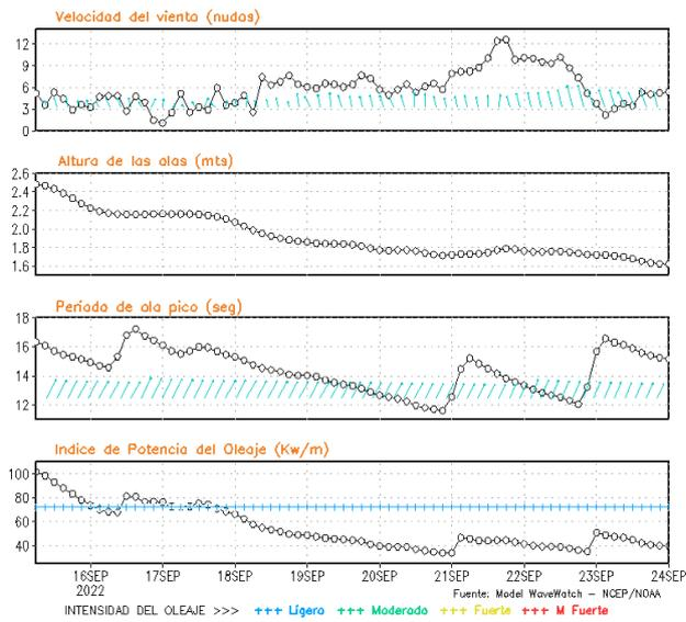
**Figura 8.** Series de tiempo de la velocidad del viento (nudos), altura de olas (m), periodo de la ola (s) e índice de la potencia del oleaje (Kw/m) frente a las costas de Talara, Callao e Ilo, del 15-09-2022 al 22-09-2022 Fuente: Datos: modelo WWATCH III; Grafico: DHN
