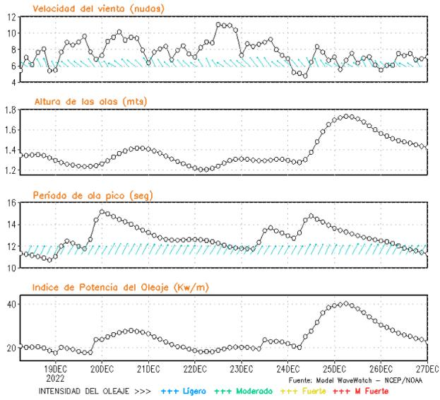
Figura 8. Series de tiempo de la velocidad del viento (nudos), altura de olas (m), periodo de la ola (s) e índice de la potencia del oleaje (Kw/m) frente a las costas de Talara, Callao e Ilo, del 18-12-2022 al 25-12-2022 Fuente: Datos: modelo WWATCH III; Grafico: DHN
