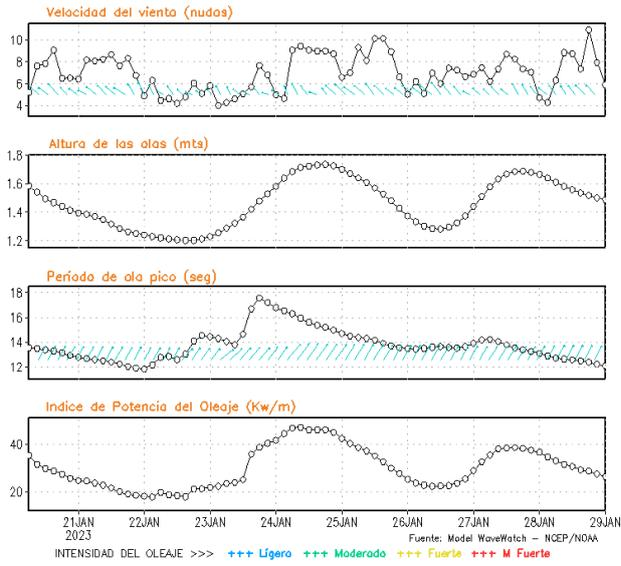
**Figura 8.** Series de tiempo de la velocidad del viento (nudos), altura de olas (m), periodo de la ola (s) e índice de la potencia del oleaje (Kw/m) frente a las costas de Talara, Callao e Ilo, del 20-01-2023 al 27-01-2023 Fuente: Datos: modelo WWATCH III; Grafico: DHN
