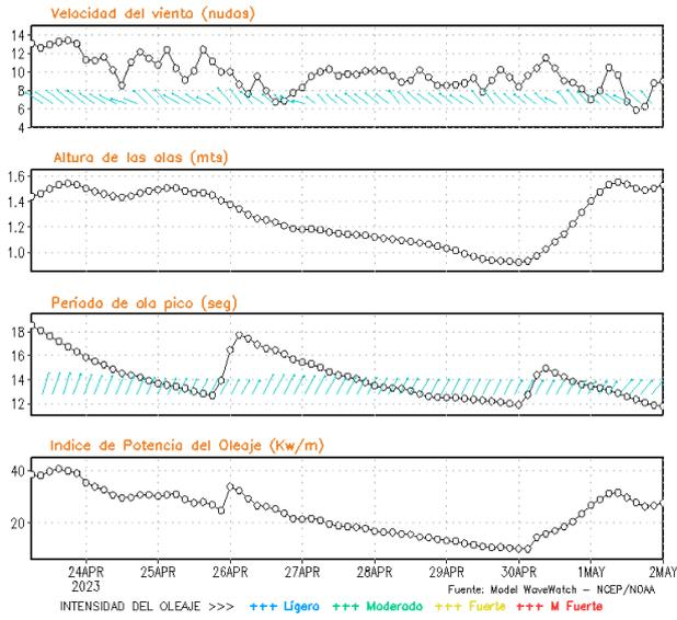
**Figura 8.** Series de tiempo de la velocidad del viento (nudos), altura de olas (m), periodo de la ola (s) e índice de la potencia del oleaje (Kw/m) frente a las costas de Talara, Callao e Ilo, del 23-04-2023 al 30-04-2023 Fuente: Datos: modelo WWATCH III; Grafico: DHN
