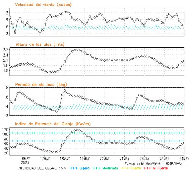
**Figura 8.** Series de tiempo de la velocidad del viento (nudos), altura de olas (m), periodo de la ola (s) e índice de la potencia del oleaje (Kw/m) frente a las costas de Talara, Callao e Ilo, del 15-05-2023 al 22-05-2023 Fuente: Datos: modelo WWATCH III; Grafico: DHN
