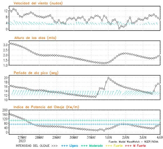
**Figura 8.** Series de tiempo de la velocidad del viento (nudos), altura de olas (m), periodo de la ola (s) e índice de la potencia del oleaje (Kw/m) frente a las costas de Talara, Callao e Ilo, del 26-05-2023 al 02-06-2023 Fuente: Datos: modelo WWATCH III; Grafico: DHN
