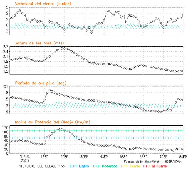
**Figura 8.** Series de tiempo de la velocidad del viento (nudos), altura de olas (m), periodo de la ola (s) e índice de la potencia del oleaje (Kw/m) frente a las costas de Talara, Callao e Ilo, del 30-08-2023 al 06-09-2023 Fuente: Datos: modelo WWATCH III; Grafico: DHN
