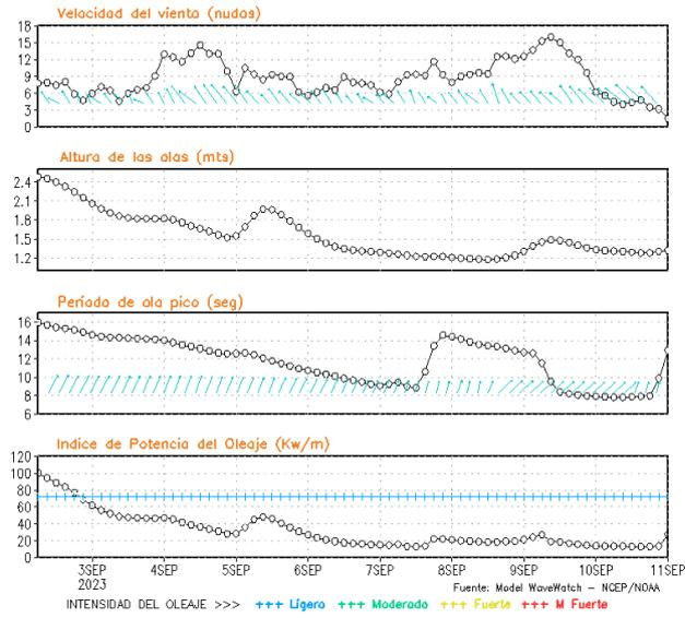
**Figura 8.** Series de tiempo de la velocidad del viento (nudos), altura de olas (m), periodo de la ola (s) e índice de la potencia del oleaje (Kw/m) frente a las costas de Talara, Callao e Ilo, del 02-09-2023 al 09-09-2023 Fuente: Datos: modelo WWATCH III; Grafico: DHN
