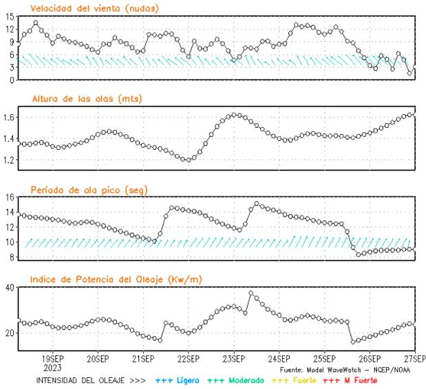
**Figura 8.** Series de tiempo de la velocidad del viento (nudos), altura de olas (m), periodo de la ola (s) e índice de la potencia del oleaje (Kw/m) frente a las costas de Talara, Callao e Ilo, del 18-09-2023 al 25-09-2023 Fuente: Datos: modelo WWATCH III; Grafico: DHN
