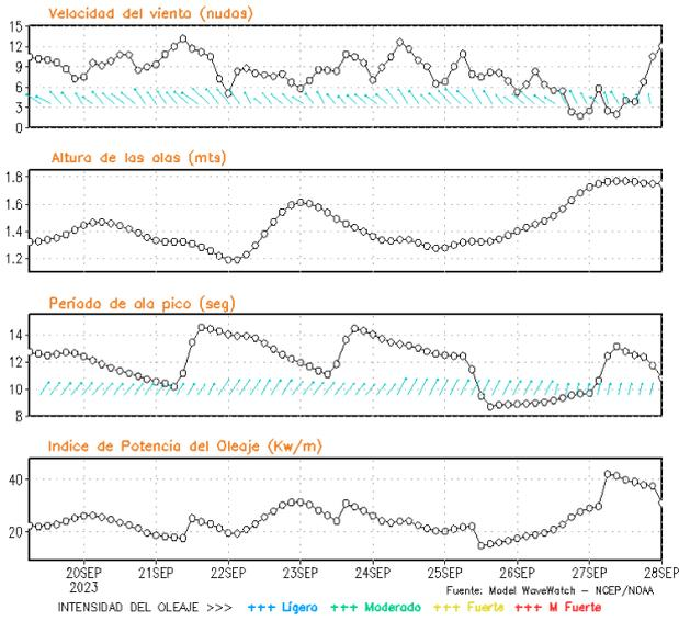
**Figura 8.** Series de tiempo de la velocidad del viento (nudos), altura de olas (m), periodo de la ola (s) e índice de la potencia del oleaje (Kw/m) frente a las costas de Talara, Callao e Ilo, del 19-09-2023 al 26-09-2023 Fuente: Datos: modelo WWATCH III; Grafico: DHN
