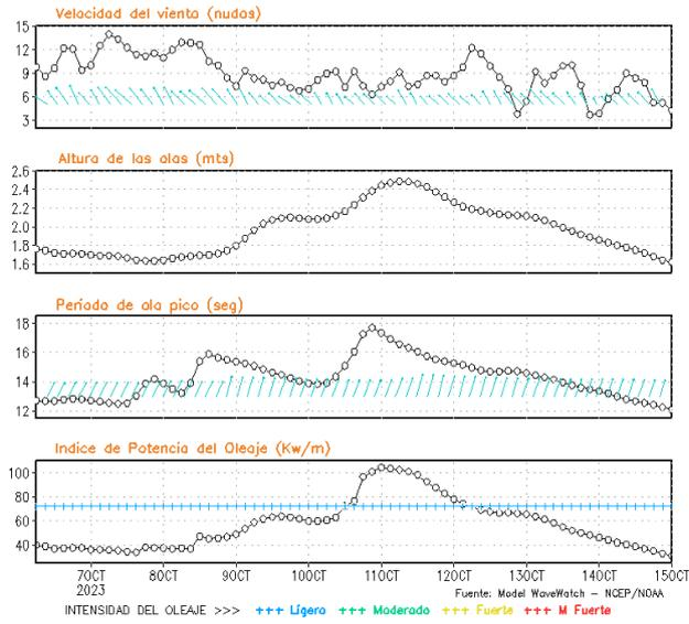
**Figura 8.** Series de tiempo de la velocidad del viento (nudos), altura de olas (m), periodo de la ola (s) e índice de la potencia del oleaje (Kw/m) frente a las costas de Talara, Callao e Ilo, del 06-10-2023 al 13-10-2023 Fuente: Datos: modelo WWATCH III; Grafico: DHN
