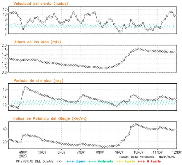
**Figura 8.** Series de tiempo de la velocidad del viento (nudos), altura de olas (m), periodo de la ola (s) e índice de la potencia del oleaje (Kw/m) frente a las costas de Talara, Callao e Ilo, del 03-11-2023 al 10-11-2023 Fuente: Datos: modelo WWATCH III; Grafico: DHN
