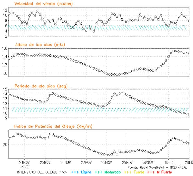
Figura 8. Series de tiempo de la velocidad del viento (nudos), altura de olas (m), periodo de la ola (s) e índice de la potencia del oleaje (Kw/m) frente a las costas de Talara, Callao e Ilo, del 23-11-2023 al 30-11-2023 Fuente: Datos: modelo WWATCH III; Grafico: DHN
