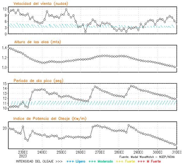
**Figura 8.** Series de tiempo de la velocidad del viento (nudos), altura de olas (m), periodo de la ola (s) e índice de la potencia del oleaje (Kw/m) frente a las costas de Talara, Callao e Ilo, del 22-12-2023 al 29-12-2023 Fuente: Datos: modelo WWATCH III; Grafico: DHN
