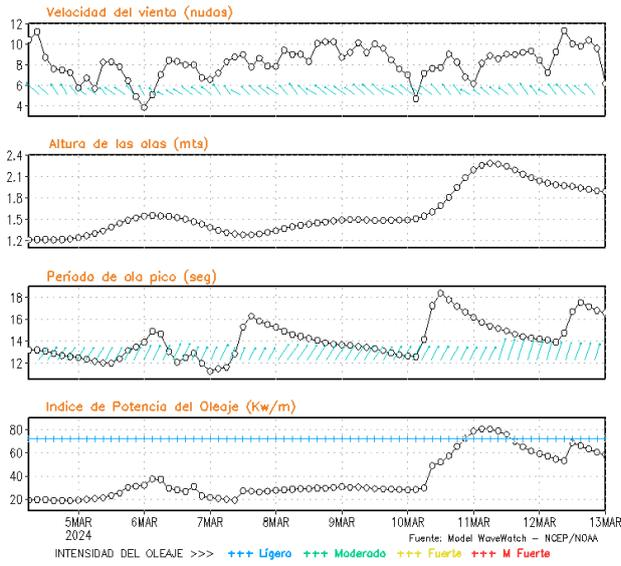
**Figura 8.** Series de tiempo de la velocidad del viento (nudos), altura de olas (m), periodo de la ola (s) e índice de la potencia del oleaje (Kw/m) frente a las costas de Talara, Callao e Ilo, del 04-03-2024 al 11-03-2024 Fuente: Datos: modelo WWATCH III; Grafico: DHN
